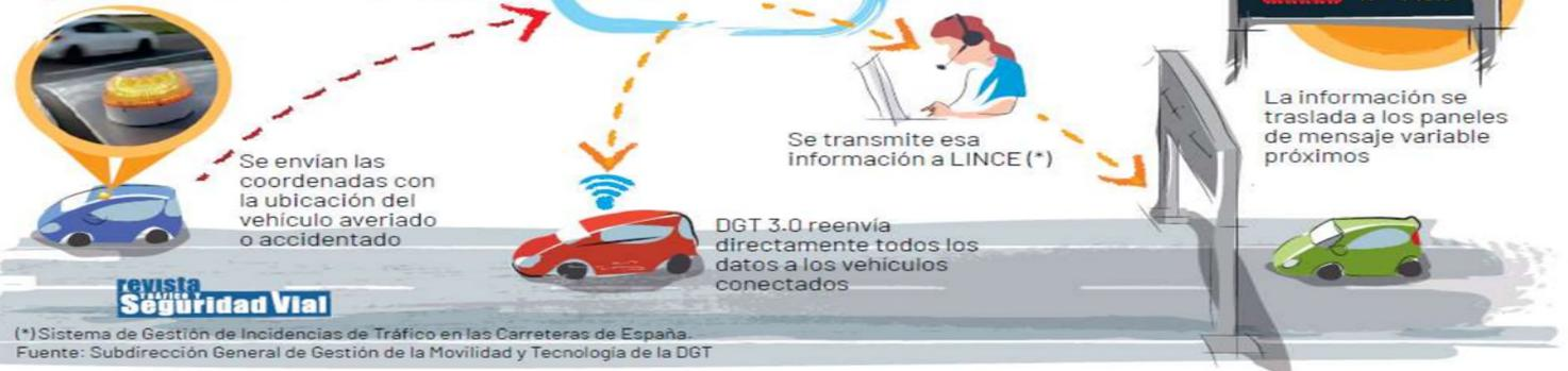
Ilustración 2. Esquema de funcionamiento de la señal V-16. Fuente: DGT
